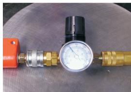
Iniziare a 3,5 bar per fissare sull'alluminio. 4 bar per l'acciaio e 5 bar per la ghisa.
