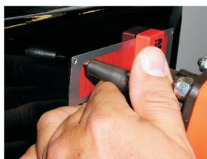
Posizionare accuratamente l'apparecchio all'angolo retto rispetto alla superficie di lavoro e applicare il Metal-Tack™ al centro del foro. Utilizzare un magnete o una striscia adesiva per posizionare provvisoriamente la targhetta durante il fissaggio.
