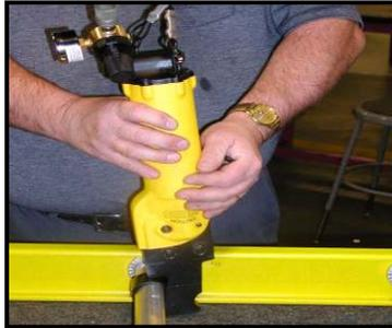
**Standard-Luft-Nietgeräte** können für die Anbringung von Befestigungselementen auf Strangguss-Teilen oder Rohrleitungen angepasst werden.
