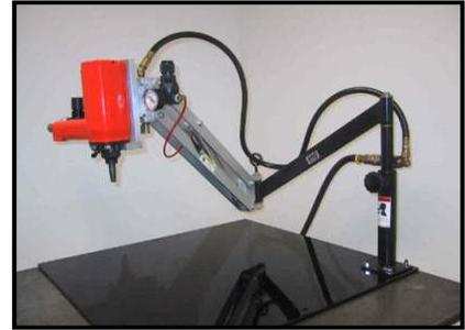
Der **Führungsarm** dient der schnelleren Positionierung und Befestigung der Metal-Tack's zur Erhöhung der Produktivität.
