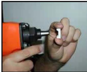
Tack-Mounts werden sicher auf der Spitze des Lufthammers mit einem magnetischen Treiber gehalten.
