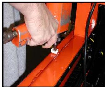
Das Gerät nur positionieren und den Auslöser für eine rasche, dauerhafte Befestigung betätigen.
