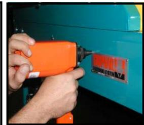
Den Metall-Tack auf die Magnetspitze des Lufthammers setzen, den Hammer gegen die Metalloberfläche drücken und den Auslöser betätigen. Kein Vorbohren und keine Reinigung.
