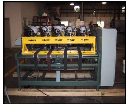
**Befestigungs-Automaten** können verwendet werden, um bis zu 300 Befestigungselemente pro Minute anzubringen.
