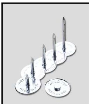
PowerPoint-Schweißstifte haben einen kapfenförmigen Kopf, der eine Beschädigung der Isolierung verhindert und eine pyramidenförmige Spitze für einen positiven elektrischen Kontakt. Verschiedene Größen sind erhältlich, um Isolierungen von 6,35 bis 50,8mm zu befestigen.
