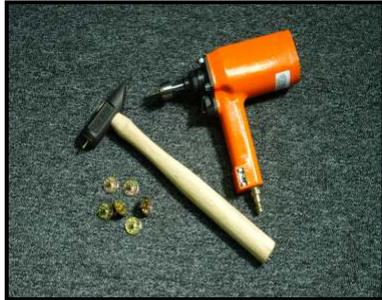
**Handwerkzeuge** wurden speziell für die Anbringung von Amtak-Befestigungselementen konstruiert und hergestellt .
