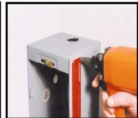
Punch-Pins können mit einem Amtak-Lufthammer eingeschossen werden.
