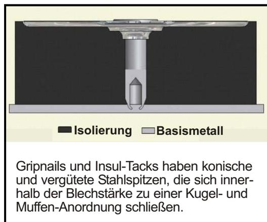
Gripnails und Insul-Tacks haben konische und vergütete Stahlspitzen, die sich innerhalb der Blechstärke zu einer Kugel- und Muffen-Anordnung schließen.
