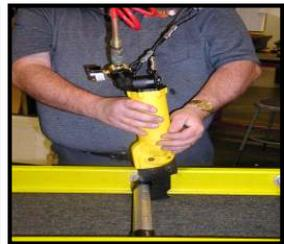
Twist-Tacks können mit einem speziellen Nietwerkzeug aufgebracht werden. Dies befestigt die Twist-Tacks durch eine Schneid-, Dreh- und Verkeil-Aktion im Basismetall.
